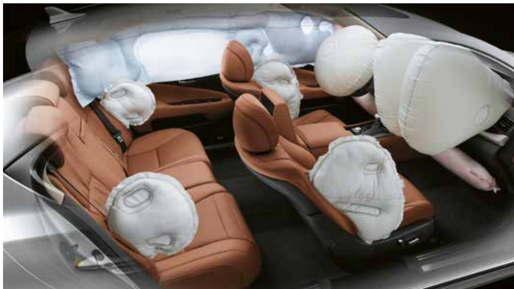
В некоторые комплектации<sup>1</sup> входит подушка безопасности заднего сиденья. Она расположена в передней части его подушки и срабатывает при фронтальном столкновении, препятствуя соскальзыванию пассажира вперед при отклоненной спинке сиденья.
